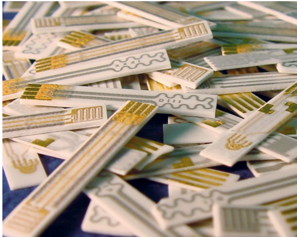
BILD 2 Prototypen der \text{NO}_x -Sensorelemente, im Dickschichtverfahren hergestellt [3] © TU Dresden)
